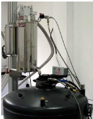
图 1 装有 reliquefier 的 PPMS
