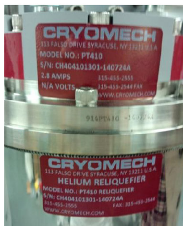
图 2 reliquefier 所使用的 PT410 冷头
